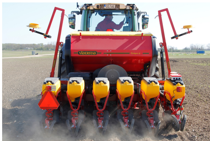
Figur 3.3: Väderstad Tempo R6 med frökartläggningssystemet installerat på såenhet nummer 6. Packarhjulet på såenheten är uppspant för att undvika att såfåran stängs vid sådd.
